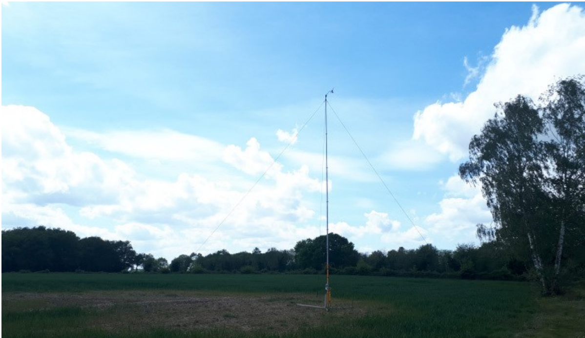
Photographie du mât de mesures météorologiques de 10 m
